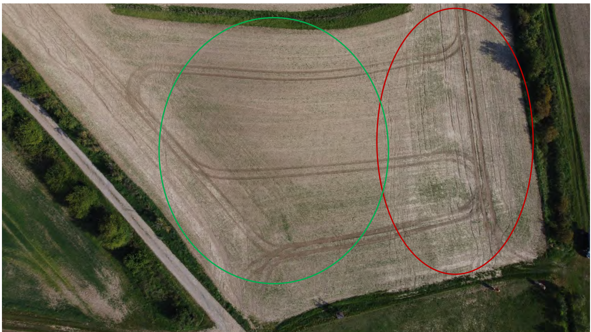
Abbildung 8: Deutlich erkennbar ist, dass es im Bereich der Retentionsstreifen keinen konzentrierten Oberflächenabfluss gibt, der das untere Ende des Schlages erreicht. Das Keyline-System hat also dafür gesorgt, dass die vor der Aufnahme stattgefundenen 60 mm und 45 mm Niederschläge in der Fläche versickert wurden, wo diese mit Keyline-Strukturen versehen sind. Es ist im Bereich des Keyline-Systems (grün markiert) jeglicher Schaden verhindert worden, der sonst zu starker Bodenerosion und erheblichen Schäden im unterhalb gelegenen
